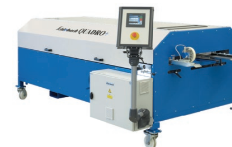
QUADRO er en elegant og fleksibel profileringsmaskine til hele 16 forskellige profiltyper.
