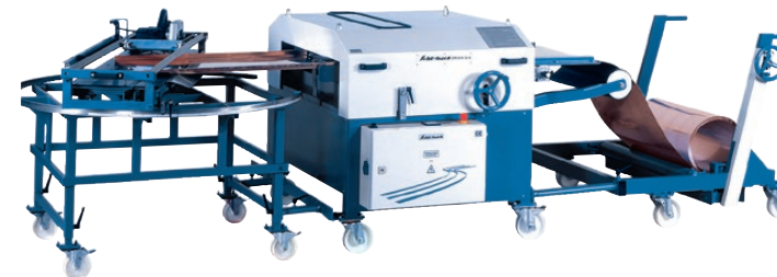
SPM 30/80 er som basismaskine en profileringsmaskine - her vist med skrå afskæringssystem og decoiler.
