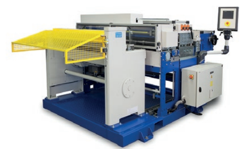
SLMST MASTERCUT 1250 / 1500 - fleksibel, præcis spalteanlæg med guillotinesaks og motoriserede rettevalser med frakørsel ved stop, så trykmærker undgås opbygget på en ramme.
