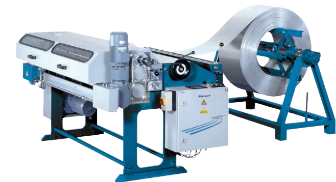
Spalteanlæg MSS 1250 med 4 par spalteknive, automatisk elektronisk rulleskær SLRST400 til tværsnit, software med spild-optimering - fås også med guillotinesaks SLTST400, rettevalser m.m.
