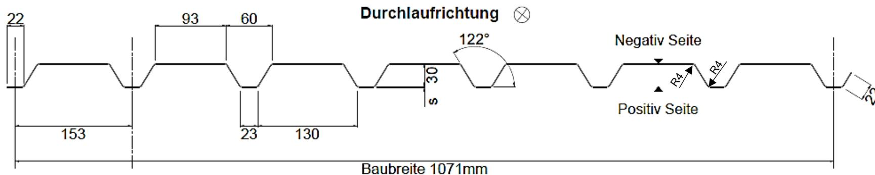
Einbausituation Dach Breite 1071mm
